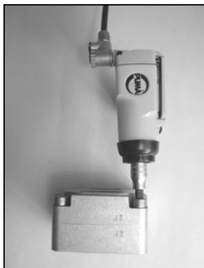
Рис. 8: Отвертка с пневмоприводом "AVV" для закрывания и открывания пресс-формы
