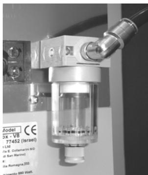
Рис. 11: Подсоединение линии сжатого воздуха
