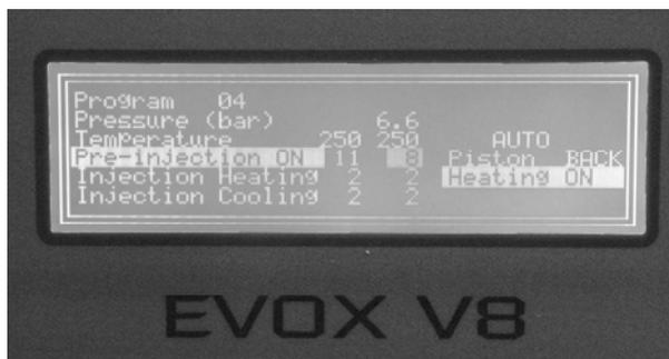
Рис. 21. Так выглядит дисплей в случае выбора автоматического режима
