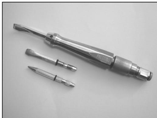
Рис. 9: Пневматический молоток Airham™ для удаления гипса из кюветы
